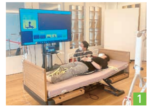
の状センサーやカメラにより利用者の状態を遠隔で確認できる見守りロボット
