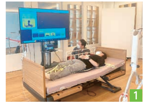
▲センサーやカメラにより利用者の状態を遠隔で確認できる見守りロボット
