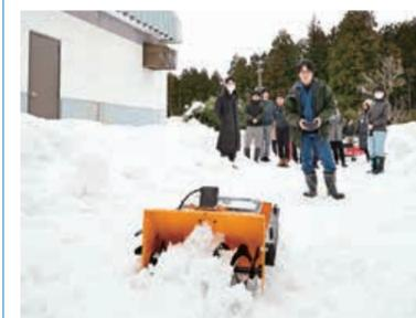
除雪作業中の事故防止や担い手不足の解消のため、開発が進む無人除雪機。屋根用と玄関先用の2種類の試作機を披露しました。
