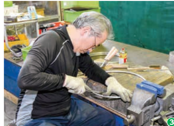
①事前合宿に訪れたオーストラリアのパラ競泳チームと交流する。水泳教室「スイム・リーダー愛」のメンバー (平成30年9月) ②悠久山プールでの同教室の活動 ③(株)オーエックスエンジニアリングの陸上競技用車いすの部品加工。設計や材質の特性を考慮し、熟練の職人が一つ一つ繊細な調整を行います
