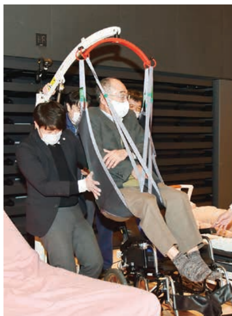
▲狭いスペースでも使用できるよう改良したベッド脱着型リフト
