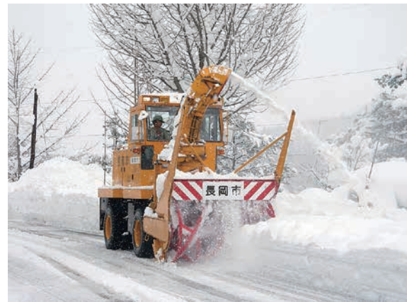
良好な除雪体制の維持 (ロータリ除雪車による拡幅除雪)
