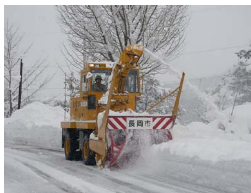
良好除雪体制の維持 (ロータリ除雪車による拡幅除雪)
