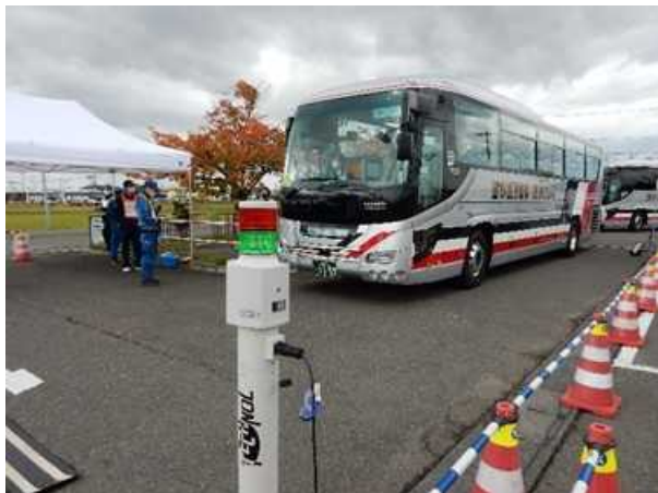
避難バスの汚染検査 （ゲートモニタ）
