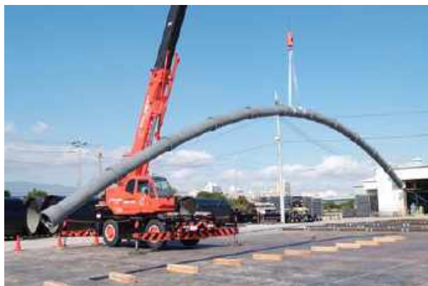
図 2-3-5-21 <<耐震化で使用する耐震管の例>>
