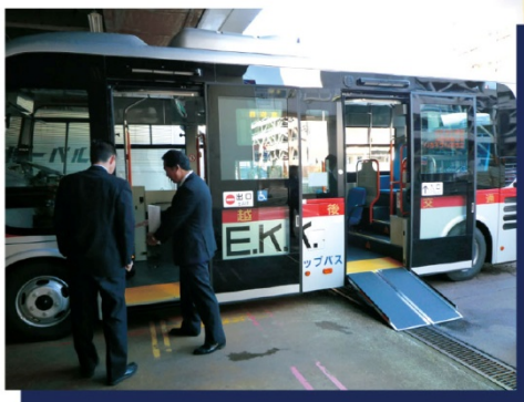
出入口の段差をなくし、誰もが乗降りしやすい「ノンステップバス」
