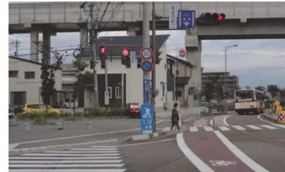
図-12 交差点における自転車専用信号の設置
