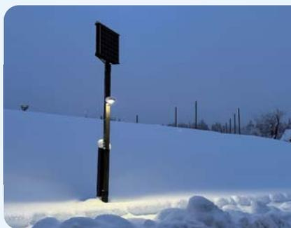
雪の多い場所でソーラー照明灯を設置しています。豪雪状況下での照明灯の性能を確認しています。
