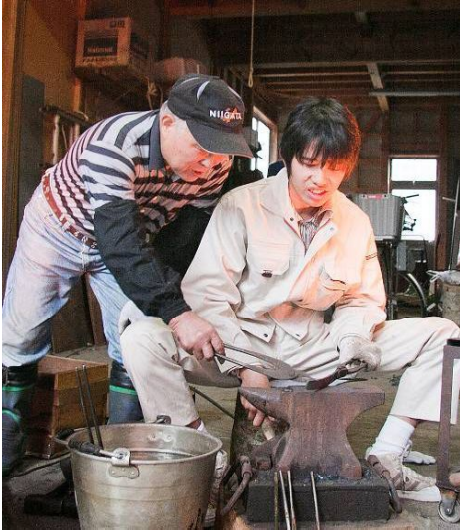
↑「鍛錬」(たんれん)焼いては叩き、叩いては焼く。この繰り返しが刃物の切れ味を生む。
