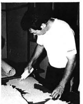
②等高線に沿って、器具を使いニクロム線の熱で発泡スチロールを切る。
