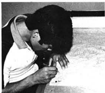
②等高線に沿って、器具を使いニクロム線の熱で発泡スチロールを切る。
