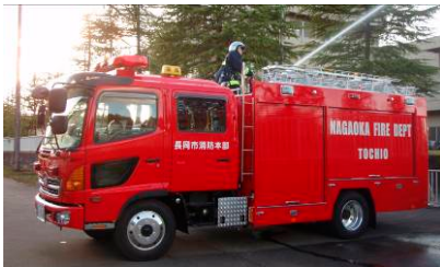
栃尾消防署に配備された災害対応型化学消防ポンプ自動車。泡消火剤 500 リットルと水 1500 リットルのタンクを装備しています。
