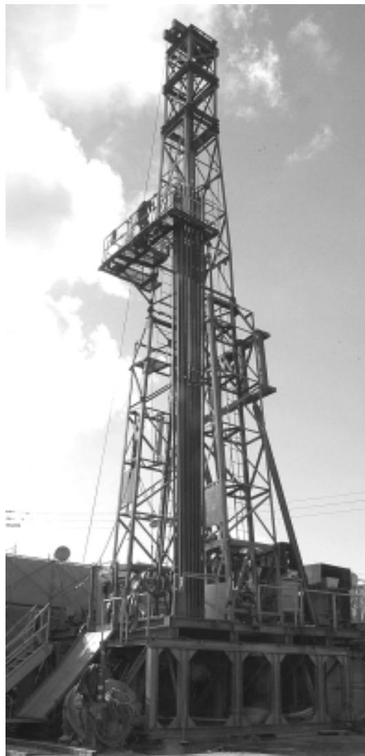
地下1,050㍉の深さまで掘るために建てられた高さ約20㍉の掘削機
