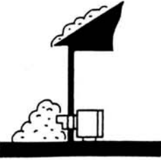
排気筒トップ埋設
