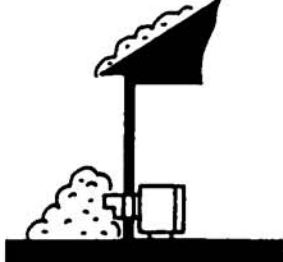
②給排気口トップ埋設
