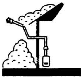
①排気筒倒壊
