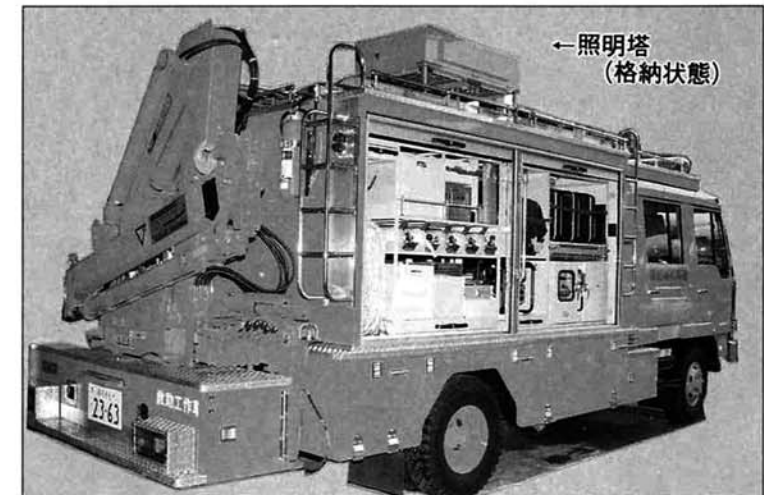
●これが救助工作車の全容です。後部に2.9トンのクレーン。車体前部には重量物の引上げに使用する5トンのウインチを設備。車体側面は救助用品をびっしり積み込んだ棚になっている。
