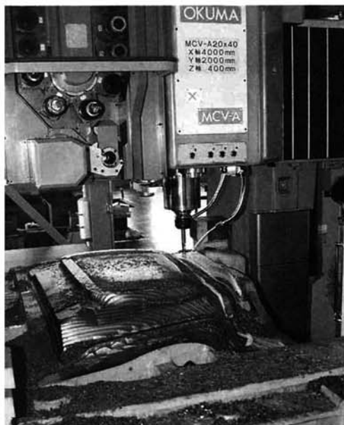
コンピューター制御された機械で、プレス金型が削り出されていく。全曜日機械をセットしておけば無人で動き、週末は完全連休二日である。
