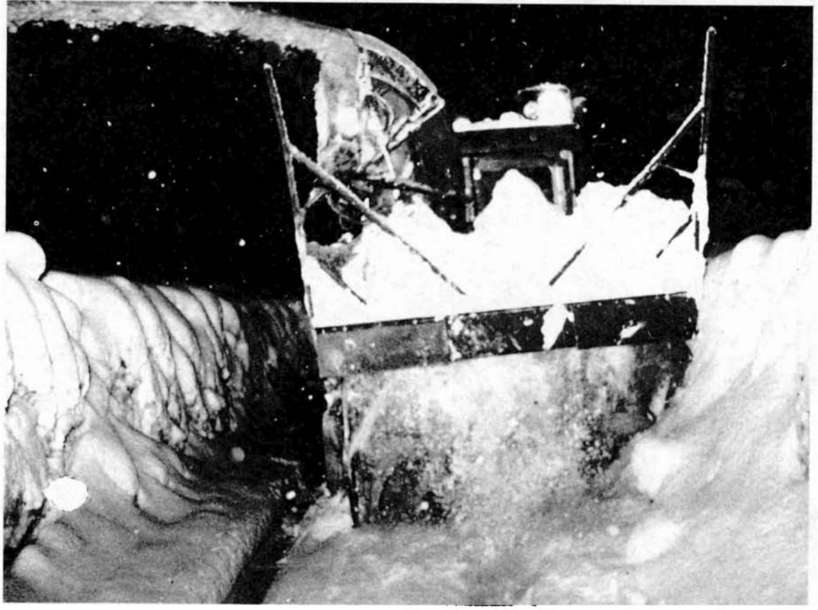
▲道路の拡幅に威力を発揮するロータリー車
