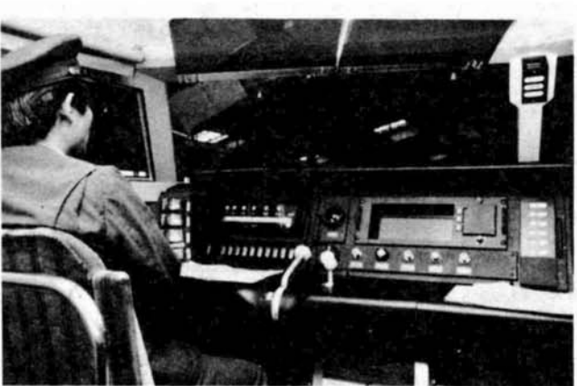
運転室 安全性が最も重視される新幹線。運転席には、テレビを利用したモニタリング装置が設けられ、車内の各種データが、一目で分かるようになっています。
