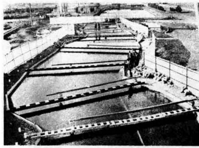
写真…毎秒9,000トンの水を流した時の模型。川の中央に見える河道からは水があふれましたが、堤防はビクともしませんでした。
