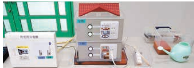
▲市の補助金を活用して開発された、水害時の漏電対策を学ぶ防災教材
