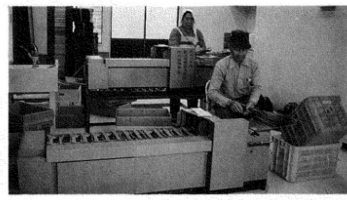
自動選別機で五段階(2L・L・A・L・M・S)に選別。
