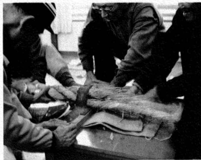
▲三つのビニールパイプを台に固定しただけの簡単なもの。この発明により縄が上手に仕上がる。
